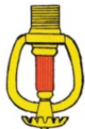
Tête de sprinklers
